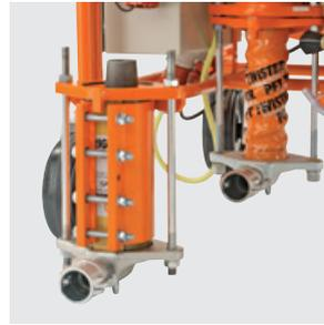
Mise en place de pompe de diamètre D ou R avec une longueur maxi de 270 mm.
