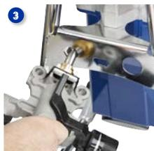
Utilisez un raccord hexagonal à châssis pour desserrer la pompe et retirez la cartouche
