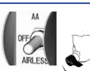
Brancher le pulvérisateur. Positionner le commutateur de sélection de fonctions sur AIRLESS. Mettre la vanne d'amorçage en position horizontale.
