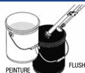
Relever le tuyau d'aspiration au-dessus du niveau de produit de rinçage et faire fonctionner le pulvérisateur pendant 15 à 30 secondes pour vidanger le produit.
