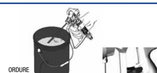
Approcher le pistolet du seau de rinçage, l'appuyer contre le seau et actionner le pistolet pour rincer soigneusement le pulvérisateur. Relâcher la gâchette et verrouiller la gâchette.
