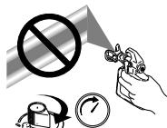
Diriger le pistolet vers la zone à pulvériser à 30 cm environ de la surface, et commencer à déplacer avant d'appuyer sur la gâchette. On obtient une bonne finition lorsque le produit se répartit de façon uniforme en touchant avec la surface. Mettre suffisamment de pression pour pulvériser sans avoir de surépaisseurs aux extrémités. Si la finition de l'application n'est pas uniforme, ajuster la taille de la buse : plus petite pour des produits plus fluides et plus grande pour des produits épais.
