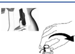
Tenir le pistolet contre le seau de peinture. Déverrouiller la sécurité de la gâchette. Actionner le pistolet et augmenter la pression jusqu'à ce que le fluide de rinçage s'écoule.
