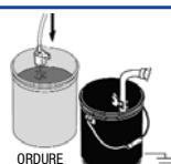
Sortir le tuyau d'application de la peinture et le plonger dans le produit de rinçage. Utiliser de l'eau pour une peinture à base aqueuse et du white-spirit pour une peinture à l'huile.
