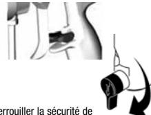
Verrouiller la sécurité de la gâchette. Mettre le tuyau de vidange dans un seau. Tourner la vanne d'amorçage vers le bas.
