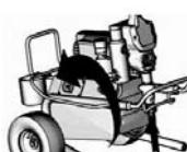
Basculer le pulvérisateur vers l'arrière. Aligner l'extrémité du tuyau d'immersion directe sur le fond de la pompe.
